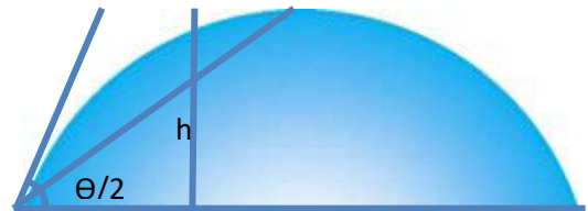
Gambar 6. Ilustrasi dari metode \theta/2 static contact angle
