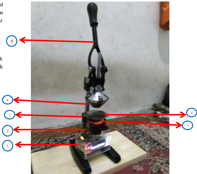
Keterangan: 1. Kontrol elektronik temperatur Hot Press, 2. Dudukan pemanas, 3. Sensor Termokopel, 4. Penyangga, 5. Tuas pres, 6. Mangkuk pencetak, 7. Koil pemanas
