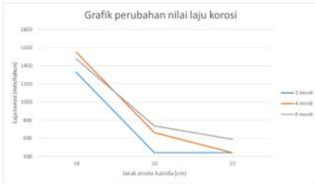
Gambar 4. Perbandingan perubahan nilai laju korosi terhadap jarak anoda-katoda pada masing-masing waktu
