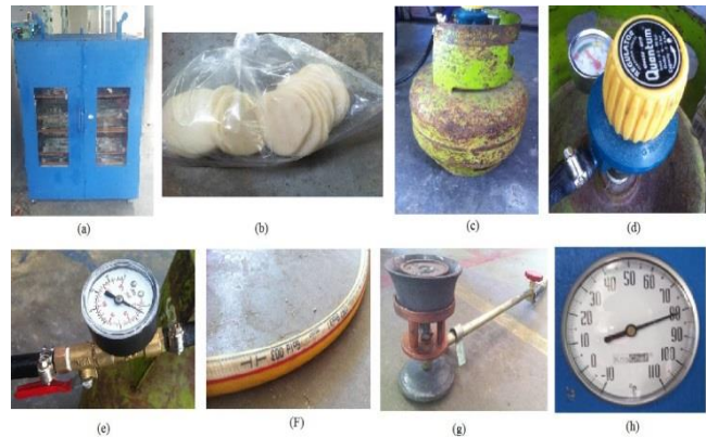
Gambar 2. Alat dan Bahan yang Digunakan (a) Alat Pengering, (b) Kerupuk, (c) Tabung Gas LPG, (d) Regulator, (e) Pressure gauge (f) Selang Gas Bertekanan, (g) Kompor Gas LPG, (h) Termometer Oven
