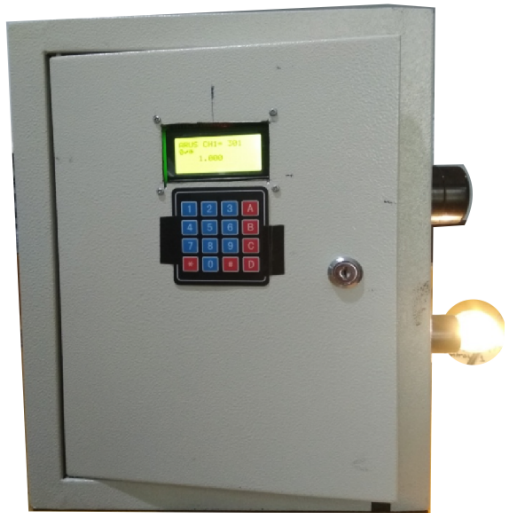
Gambar 7. Hasil rancangan alat ukur konsumsi energi listrik
