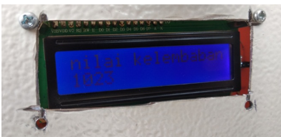
Gambar 17. Hasil pengujian LCD 16x2.
