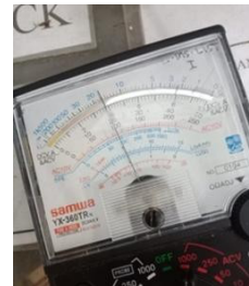
Gambar 5. Pengukuran Motor Diameter 0,6 Tanpa beban
