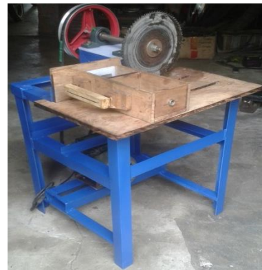
Gambar 3: Rancangan Alat Pengiris Tempe
