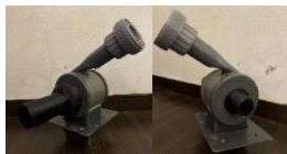
Gambar 17. Konstruksi fisik turbin crossflow portabel hasil modifikasi
