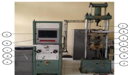
Gambar 8. Alat Uji Bending Universal Testing Machine [ Politeknik Negeri Lhok seumawe 2020]
