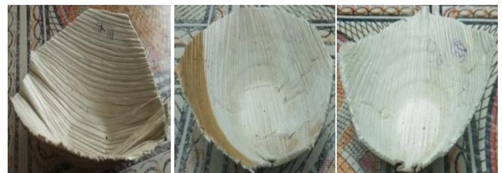
Gambar 1. Karakteristik permukaan atas hasil pengepresan dengan temperatur: (a) 110 °C, (b) 120 °C, dan (d) 130 °C
