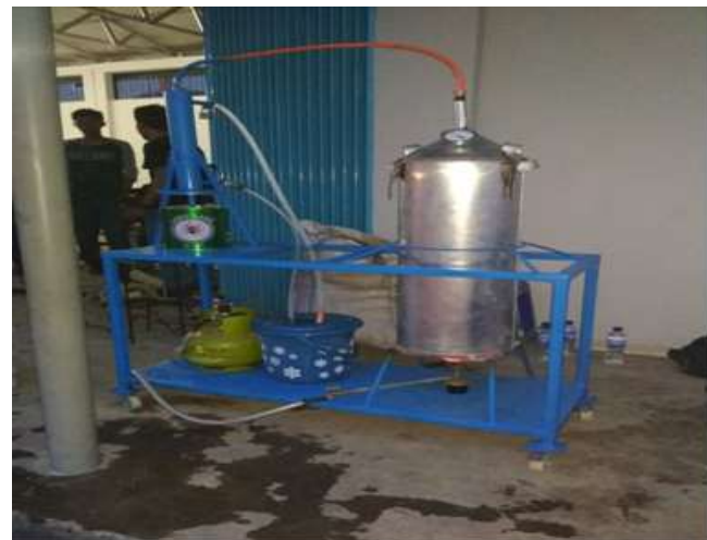
Gambar 4. Rancang Bangun Alat Penyuling Minyak Atsiri Tumbuhan Nilam Metode Distilasi Air dan Uap
