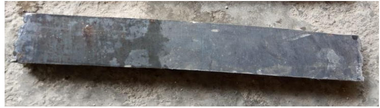
Gambar 5. Spesimen plat 11 mm dipotong dengan ukuran 150 mm x 30 mm x 11 mm
