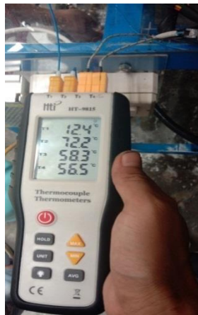
Gambar 4. Pengukuran Temperatur Refrigeran
