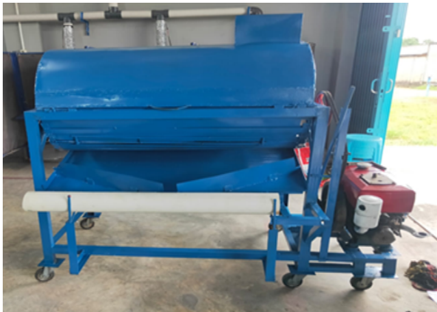
Gambar 5. Mesin Pengupas Pinang Belah Kering Model Thresher
