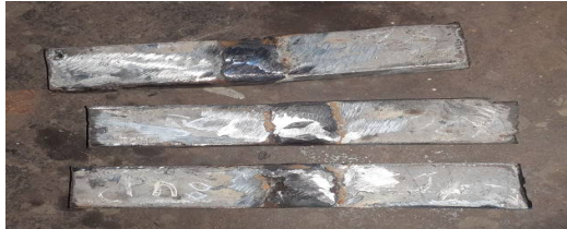
Gambar 3. Spesimen Plat Kapal Cargo HLB4P004
