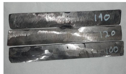
Gambar 4. Spesimen Plat Kapal Cargo HLB4P004 untuk Uji Bending
