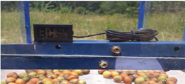
Gambar 1. Pemasangan alat ukur temperatur pada alat pengering
