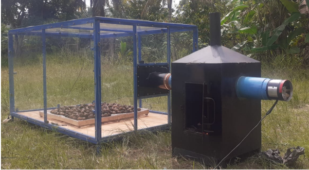
Gambar 5. Pengujian kinerja alat pengering hibrid sumber matahari dengan bahan uji
