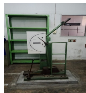
Gambar 3. Pengujian Charpy dan Izod.
