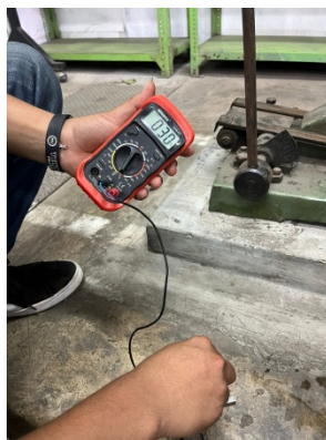
Gambar 5. Pengukuran Temperatur Spesimen.
