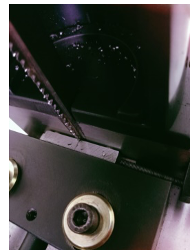
Gambar 2. Membuat Takik Spesimen
