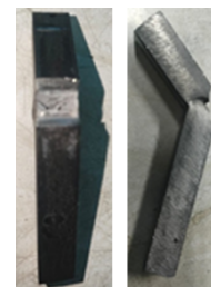
Gambar 8. Spesimen Izod setelah di uji
