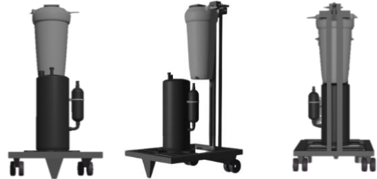
Gambar 4. Desain Prototype Alat Bantu Proses Penggantian Oli Pada Kendaraan Bermotor
