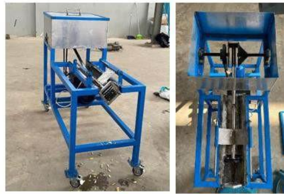
Gambar 2. Hasil Rancang Bangun Alat Pemotong Kentang
