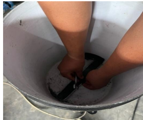
Gambar 5 Proses Perakitan Casing ke Rangka
