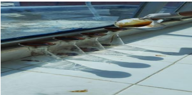
Gambar 4. Proses Filtrasi Limbah Pada Membrane Komposit
