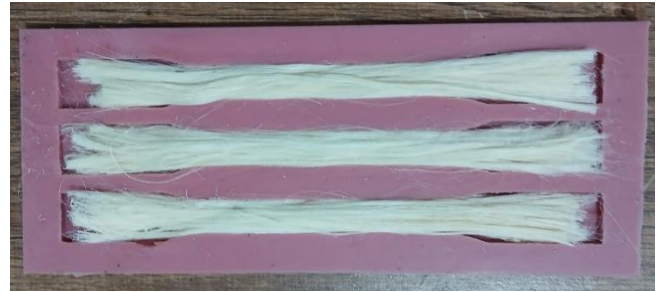
Gambar 4. Proses Pencetakan Spesimen ASTM D638
