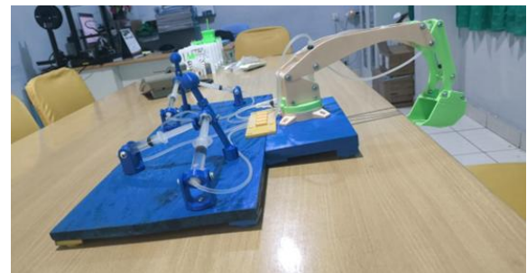
Gambar 2. Hasil Cetak 3D Simulator Excavator
