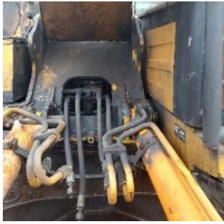
Gambar 2. Kebocoran Pada Hydraulic Hose
