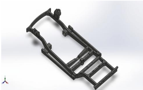
Gambar 1. Geometri 3D model sasis semi-ladder frame hasil pengukuran langsung di lapangan
